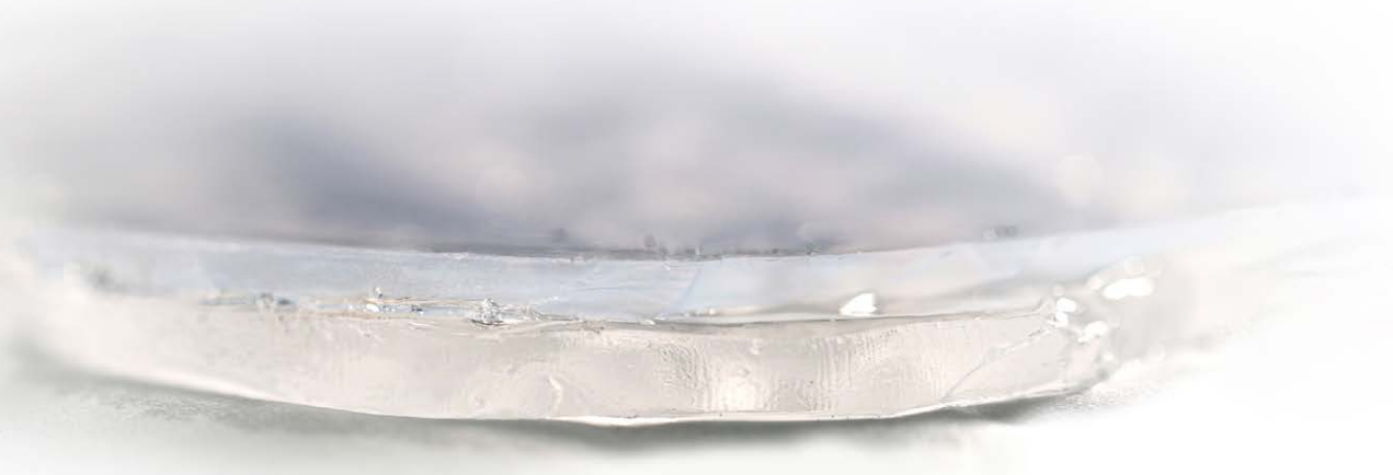
Новый двухслойный материал из гидрогеля и аэрогеля (MIT / CC BY-NC-ND 3.0)
